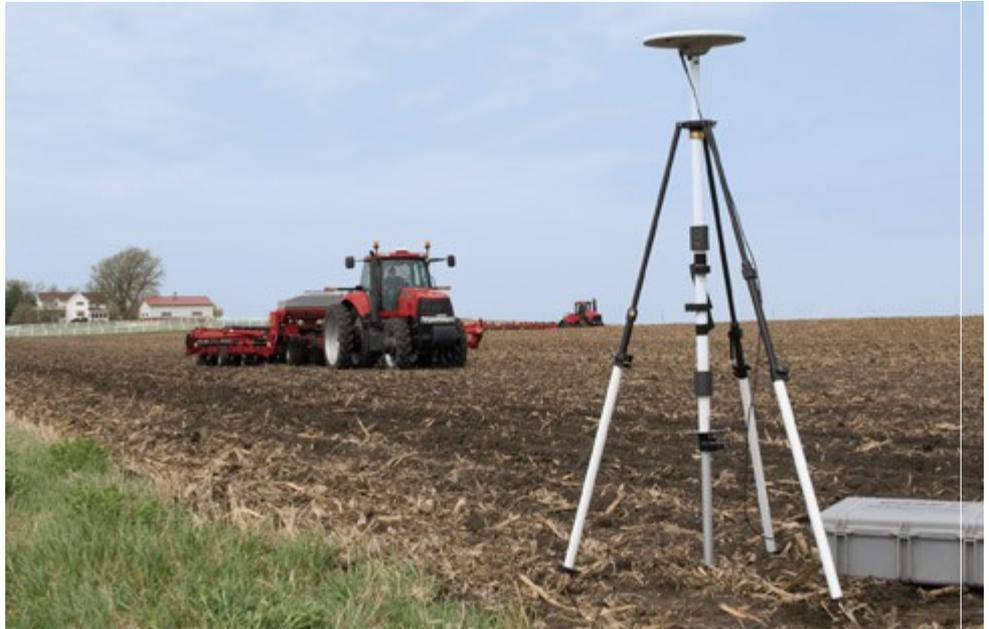
L'aumento della precisione di guida si basa sul calcolo della posizione in cui si trova la macchina, istante per istante. Questo può essere ottenuto tramite sistemi laser o segnali generati da satelliti simili ai quelli GPS utilizzati per gli scopi più vari, ma con satelliti diversi, al fine di ottenere migliore precisione.
