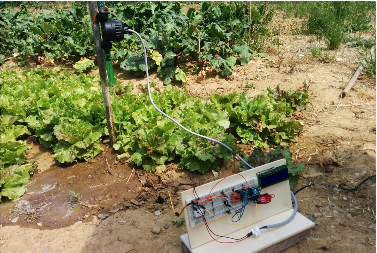
Il circuito elettronico funziona correttamente con alimentazione a 9V tramite trasformatore e il ruolo del sistema viene svolto correttamente. La scheda Arduino processa correttamente i dati e attiva l'irrigazione al momento giusto. L'elettrovalvola funziona correttamente.
